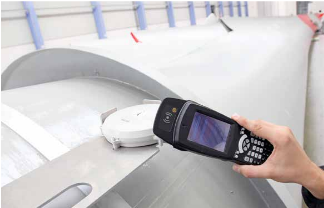
Batteriebetriebene Ortungssysteme mit GPS und Bewegungssensor melden jede Umlagerung © Fraunhofer IFF, Dirk Mahler
